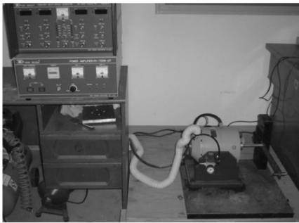
图5 高频电磁激振器
