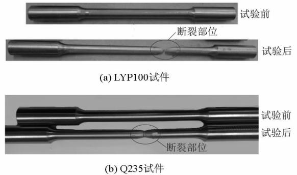
图 4 试件试验前后图
