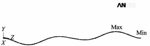
图 4 二阶振型  $f_2 = 25.446\text{ Hz}$
