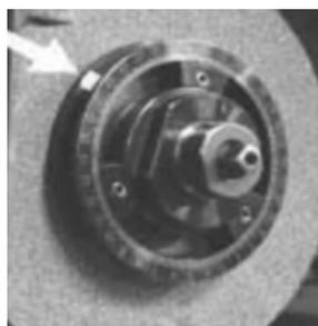
图 2 3 个平衡块的砂轮法兰盘
