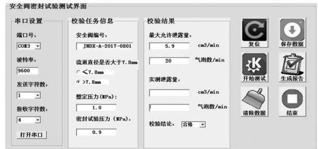
图4 安全阀密封试验测试界面
