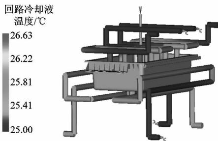
图 10 回路冷却液温度
