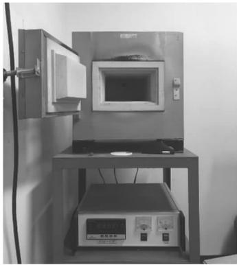
图3 SX2-5-12 型箱式电阻炉
