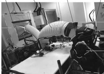
图5 HVAC 模块风量测试安装
